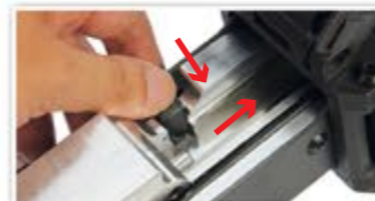
1. フィードトレイカバーを開き、チャージャーリリースボタンを押します。
