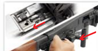
拉動槍機拉柄，直到將彈道調整裝置卡入到位並發出喀嗒聲。
