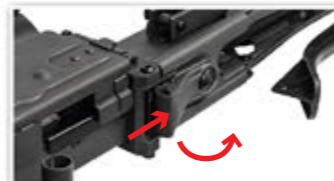
2. サイドカバーを前方に押しながらバレルを取り出します。
